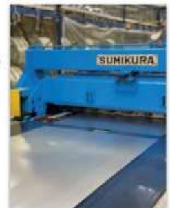
鉄鋼メーカーから仕入れたコイルをスリッター、レベラー、シャーリングでお客様の要望のサイズに切断加工します。
