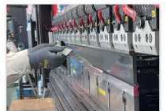
切断加工をしたものをプレスベンダーなど機械で曲げていきます。
